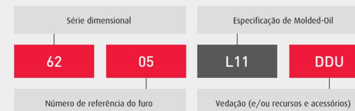
Conforme demonstrado neste exemplo para rolamentos fixos de esferas com vedação NSK, a especificação do Molded-Oil precede as características e acessórios do projeto em sistemas de numeração para todos os tipos de rolamentos.
