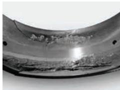
Foto: escamação do anel externo e danos de fissuras.
