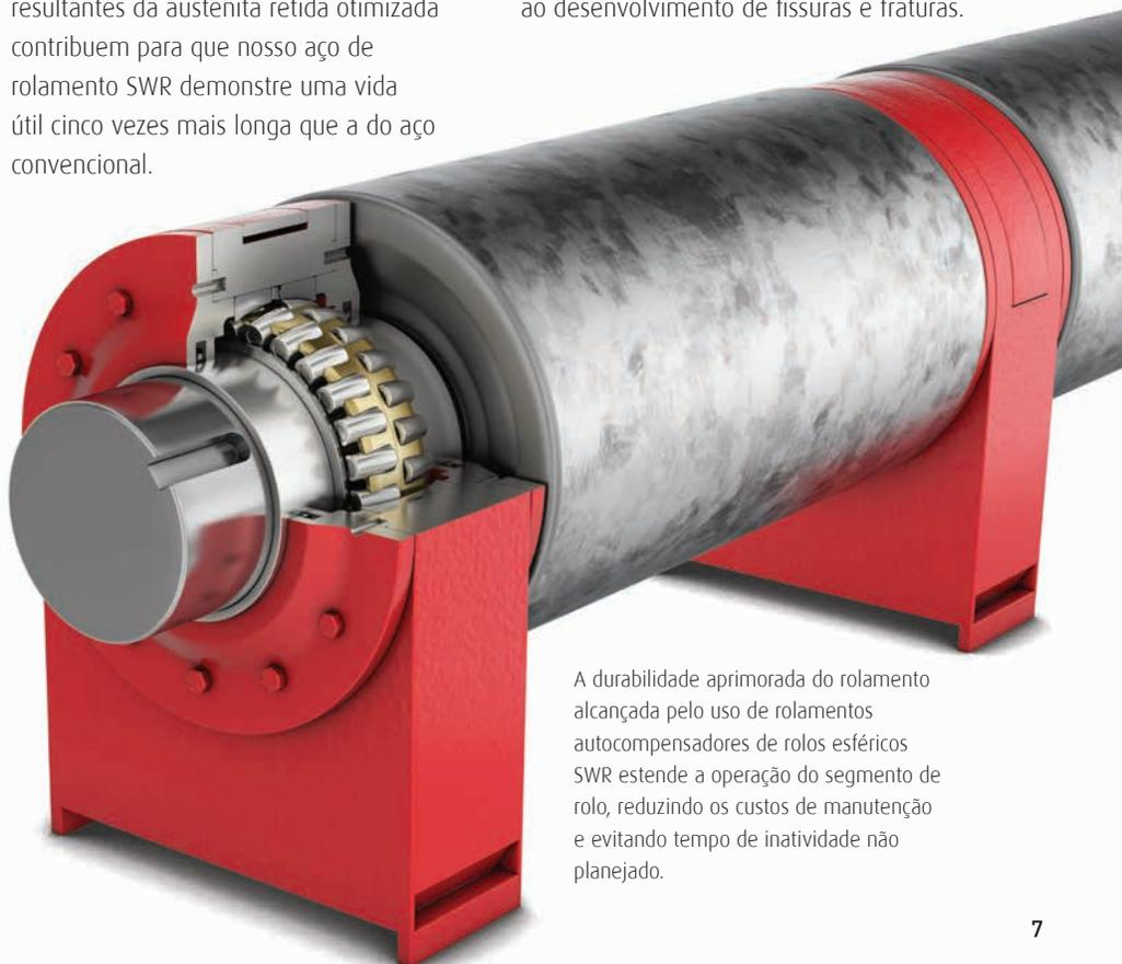
A durabilidade aprimorada do rolamento alcançada pelo uso de rolamentos autocompensadores de rolos esféricos SWR estende a operação do segmento de rolo, reduzindo os custos de manutenção e evitando tempo de inatividade não planejado.
