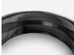
Foto: desgaste do anel externo
